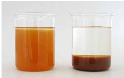
◀凝集沈殿イメージ 左：凝集沈殿前 右：凝集沈殿後
