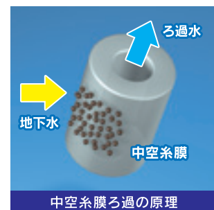
中空糸膜ろ過の原理
