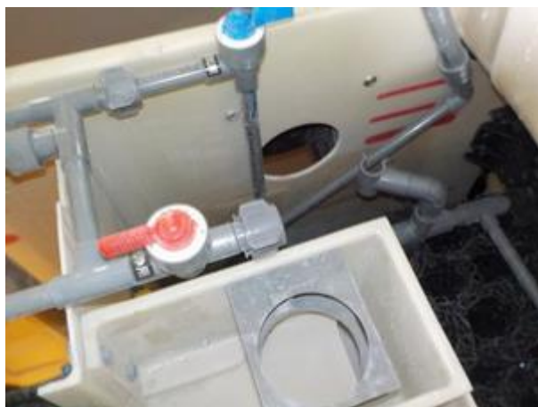
⑥上記の逆の手順にて配管を復旧し、バルブも元の位置に戻す
