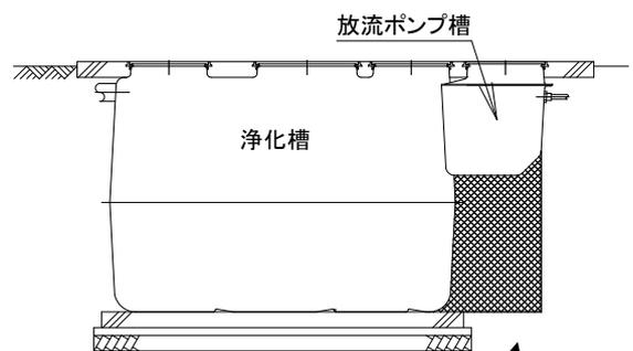
埋め戻しの際、放流ポンプ槽の底部および浄化槽とポンプ槽の隙間には十分土を入れてください。
