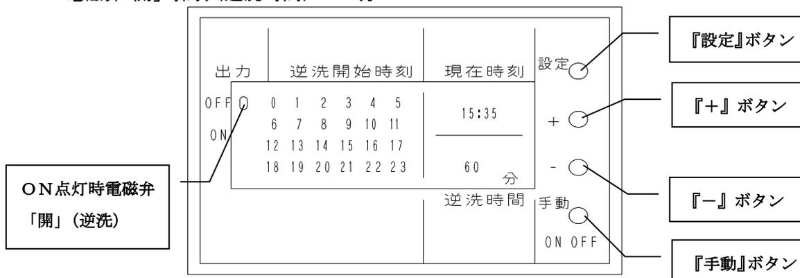
図 17 ブロウ組み込み型のタイマ
