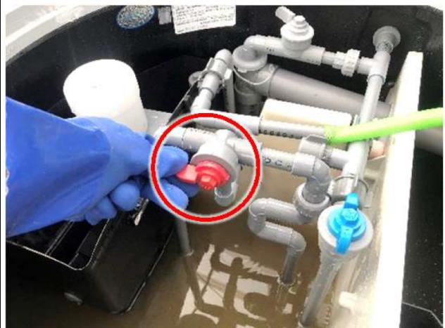
②引抜いた配管(2)に水道ホースを接続する
