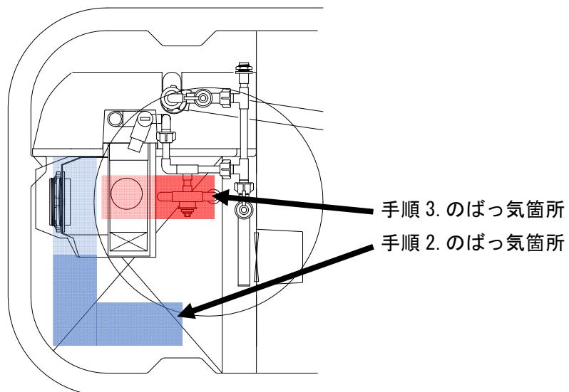
図 罂材洗浄装置ばっ気箇所
