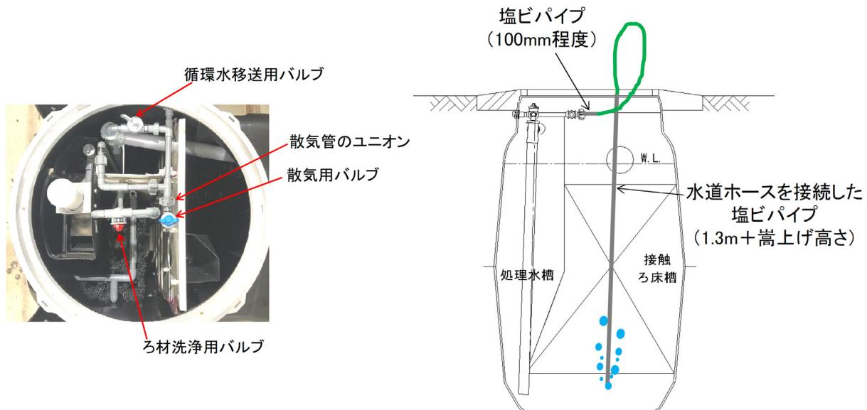
(4) 処理水槽および処理水移送装置
