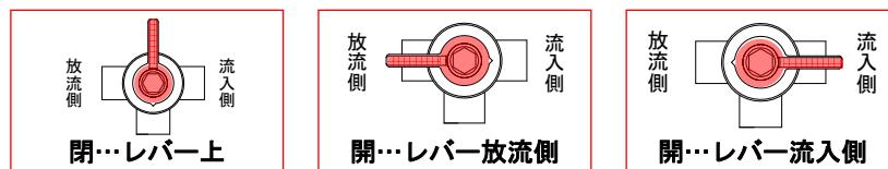
図 5、7人槽罂材洗浄用バルブ（赤）操作
