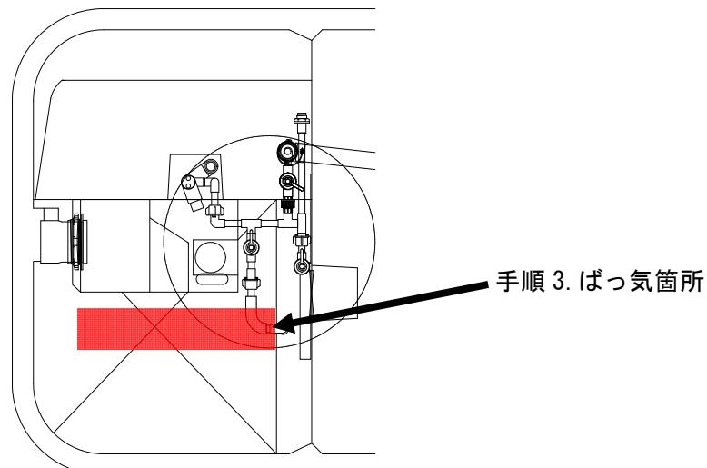
図 ろ材洗浄装置ばつ気箇所
