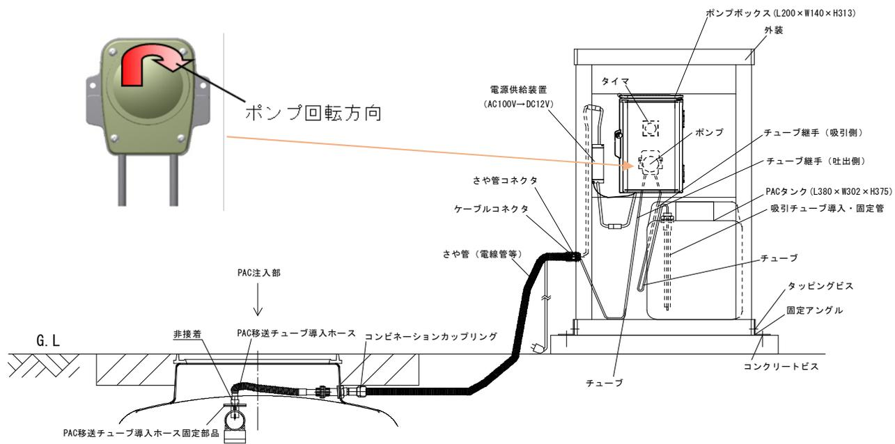
図 リン除去装置の概要
