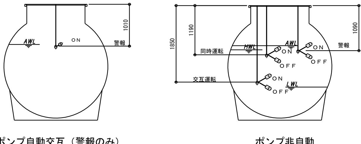
図5 フロートスイッチ設定位置（図はかさ上げ無しの場合）
